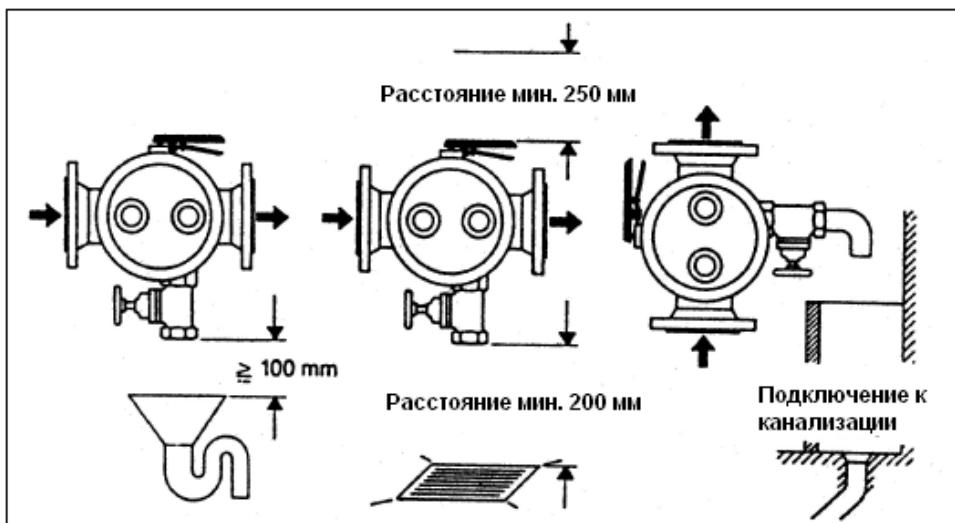
Промывка фильтра осуществляется под постоянным водяным давлением. При установке и вводе фильтра в эксплуатацию, необходимо на несколько секунд открыть сливной вентиль, для того, чтобы удалить из фильтра воздух.
